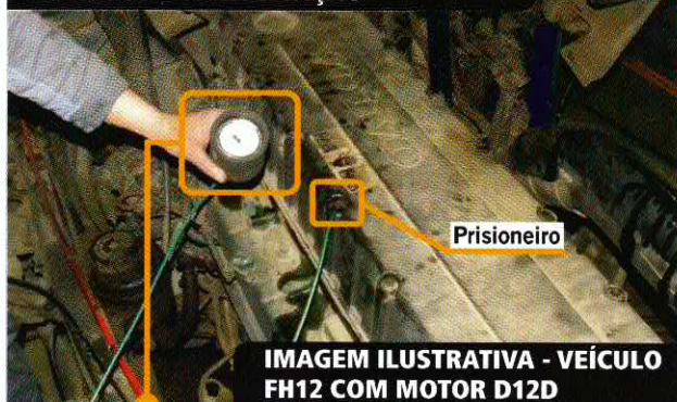
FIGURA 3 - CONEXÃO DO MANÔMETRO NO TUBO DE ALIMENTAÇÃO
