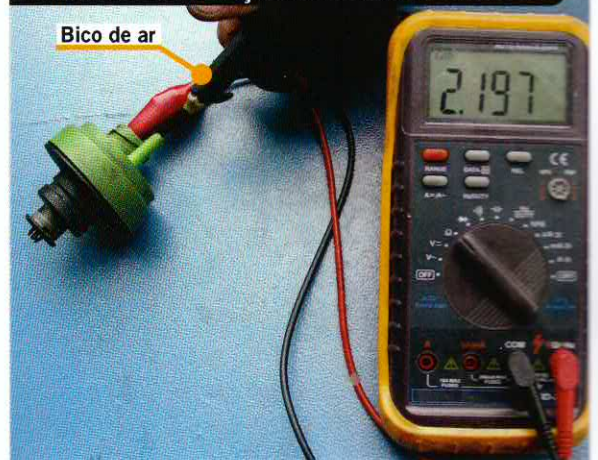
FIGURA 3 - SIMULAÇÃO DE FILTRO OBSTRUÍDO
