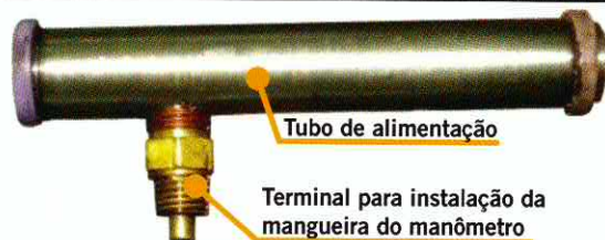
FIGURA 2 - FERRAMENTA ESPECÍFICA PARA O TESTE DA PRESSÃO DE ALIMENTAÇÃO DOS BALANCINS
