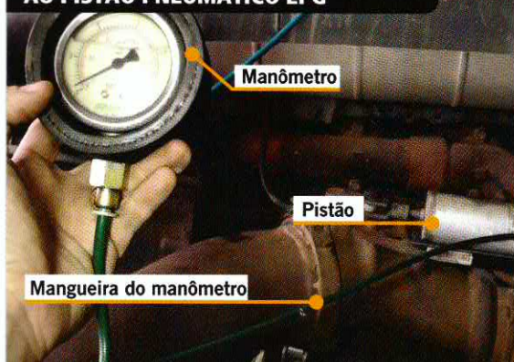
FIGURA 1 - CONEXÃO DO MANÔMETRO AO PISTÃO PNEUMÁTICO EPG
